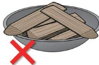
18. [D'accord aux schémas ci-dessus] Les bûches doivent bien s'introduire À L'INTÉRIEUR du bol, permettant au couvercle en grille de s'ajuster solidement et uniformément. Il ne doit jamais y avoir trop de bûches et ne doivent jamais être trop hautes, ni dépasser le périmètre du bol.
